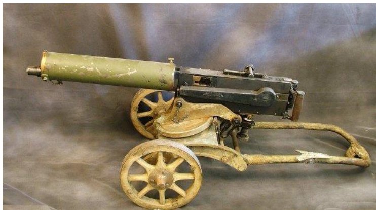
Рис. 2. Пулемёт Максима образца 1910 г. (Индекс ГРАУ – 56-П-421)
